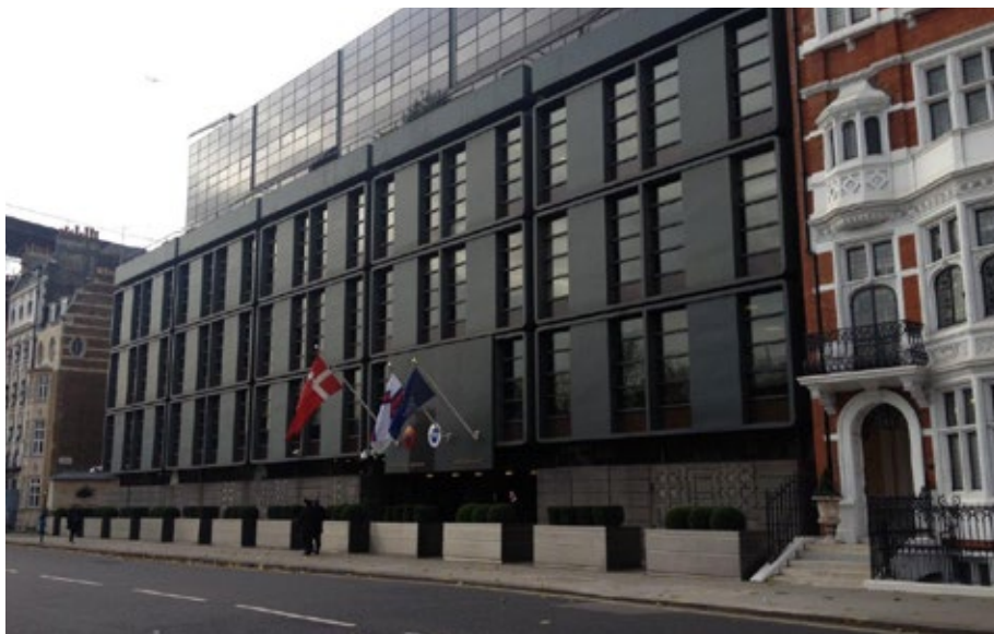
Ved å integrere sikkerhet i tidlig planlegging kan barrierene være i stil med øvrige omgivelser. Disse blomsterpottene markerer både en grense og er effektive mot kjøretøy. (Foto: NSM)
